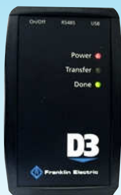
D3 (Descarga datos del Submonitor a la PC)
